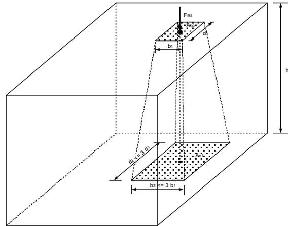
Pour satisfaire la condition  $h \geq b_2 - b_1$  et  $h \geq d_2 - d_1$ , nous retiendrons l'égalité d'où  $d_2 = d_1 + h$  et  $b_2 = b_1 + h$ . Les bielles moyennes ont une inclinaison  $\theta$  telle que  $\cot\theta = 0,25$ .
