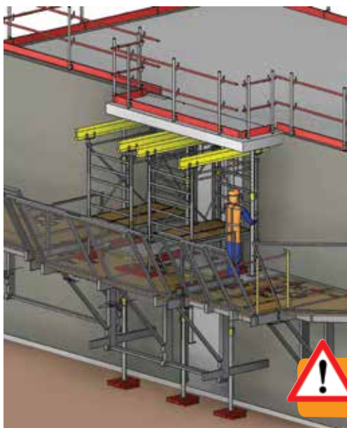
Fig. 21 • Décoffrage et pose des étais de séchage à l'avancement (sous-étaieiment).
