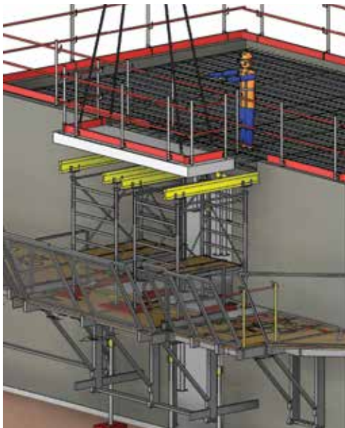
Fig. 18 • Pose du balcon (avec garde-corps intégrés).
