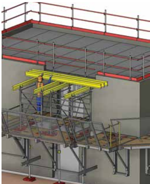
Fig. 11 • Mise en place de l'étaie et du réseau de poutrelles primaires et secondaires.
