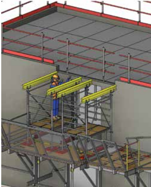
Fig. 17 • Mise en place de l'étaieiment.
