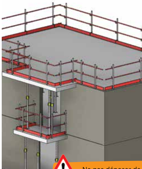
Fig. 22 • Maintien des étais de séchage (28 jours, sauf justification particulière).
